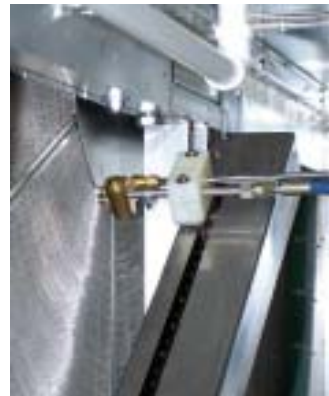
Automaattinen korkeapainevesi- puhdistuslaite Automatic cleaning device for pressurized water
